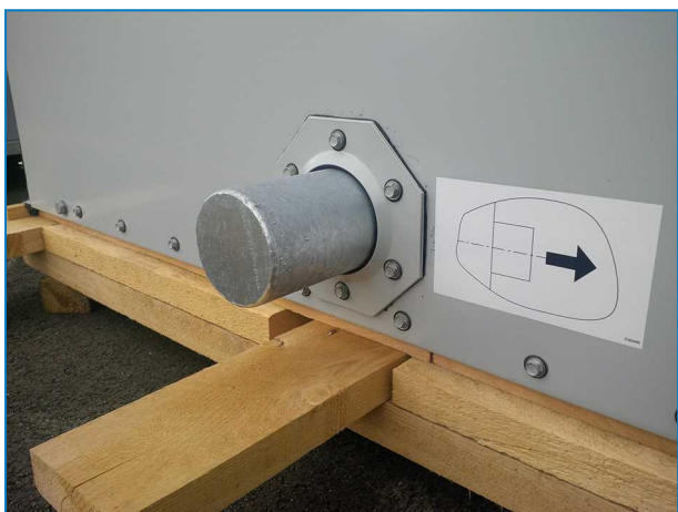
Соединение низкого перекрытого теплообменника в градирнях закрытого типа с соединениями больше, чем ND100.
