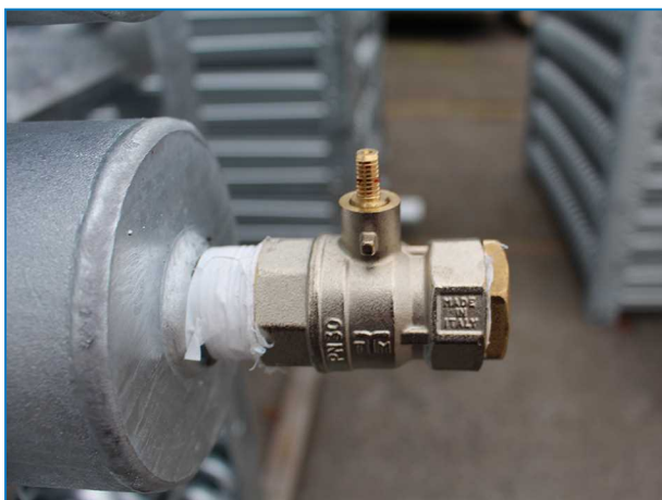
Bovenste batterijaansluiting met drukafslaatklep op koeltorens met gesloten kringloop met aansluitingen groter dan ND100.
