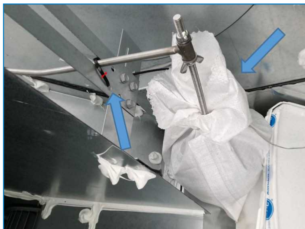
Az úszó rögzítése és csomagolása
