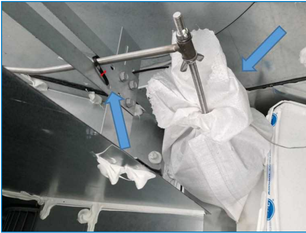
Befestigung und Umhüllung der Schwimmerkugel
