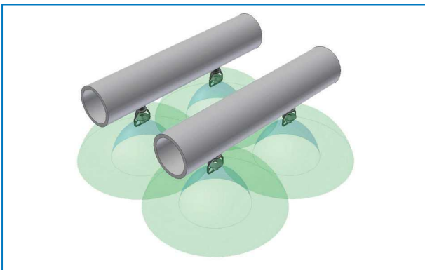
Kühlturm mit geschlossenem Kreislauf des Düsenverteilungstyps
