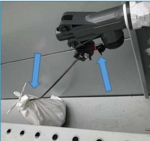
Befestigung und Umhüllung der Schwimmerkugel
