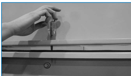
Использование штифта для выравнивания резьбовых отверстий
