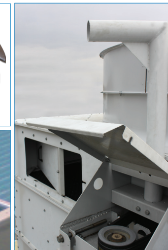
Porte d'accès coulissante vers l'intérieur. Moteur avec dispositifs de réglage extérieurs et dispositif de dépose*
