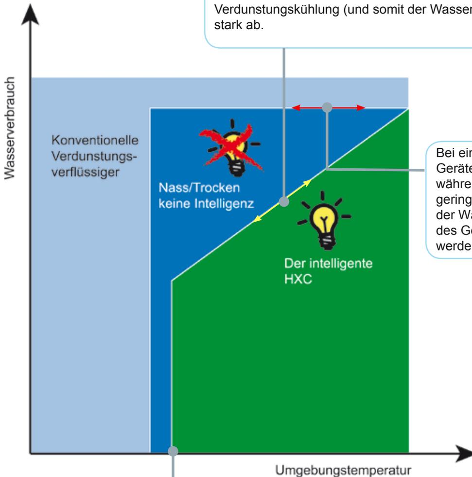
Bei einfachen Nass/Trocken Geräten ist die Wasserersparnis während des Nassbetriebes sehr gering, da der Großteil der Wärme im Nassteil des Geräts abgeführt werden muss.
